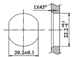
**Panel cut-out 安装孔尺寸**
