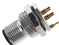
M12 公头面板式，PCB型，前锁安装，屏蔽针
