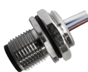
M12 公头面板式，焊接式，前锁安装
