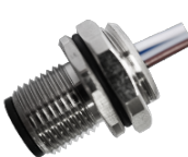
M12 公头面板式，焊接式，前锁安装
